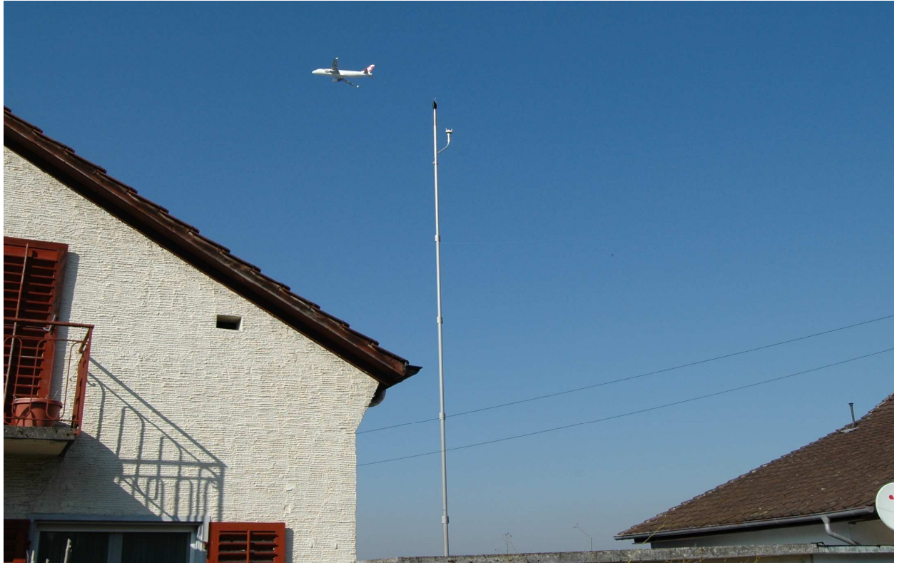
Abbildung 1: Ortsfeste Lärmmessstelle: Mast mit Mikrofon (links) und Wettersensor (rechts); der Schallanalysator befindet sich im Innern des Gebäudes
